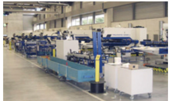
Im Stammsitz Ditzingen von Trumpf werden Stanz-Laser-Maschinen Trumatic 6000 Laserpress gebaut. Die Fließlinie besteht aus 10 Stationen. Die Maschinen werden mittels Luftkissen von Station zu Station transportiert.
